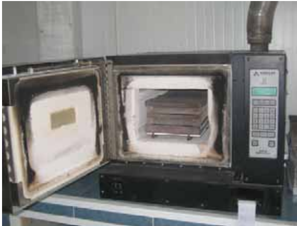
Horno de ignición, capaz de quemar todo el ligante que lleva la mezcla.
