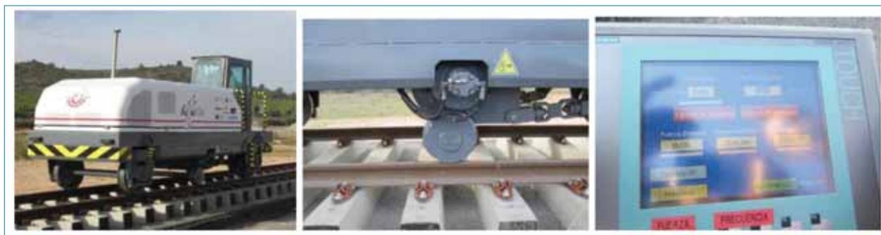
Figura 10. Fotografías del DEV, núcleo de vibración y pantalla de control.
