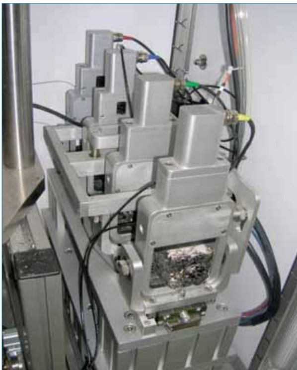
Figura 1. Ensayo de fatiga a flexotracción en 4 puntos.
