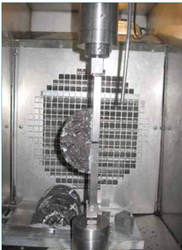
Foto 2. Montaje de probeta para el ensayo Fénix
