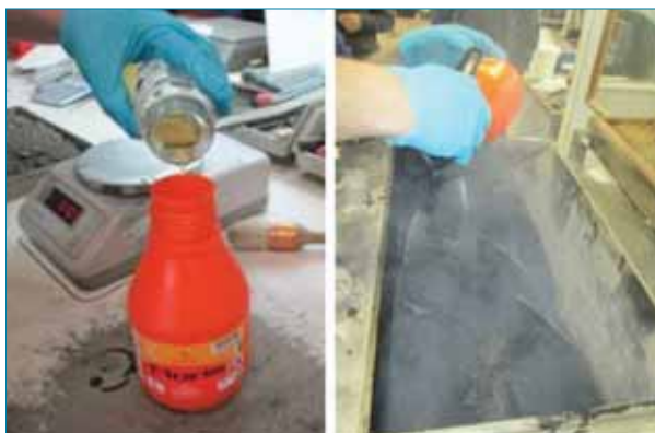
Figura 5. Pretratamiento del RAP con el aditivo rejuvenecedor.
