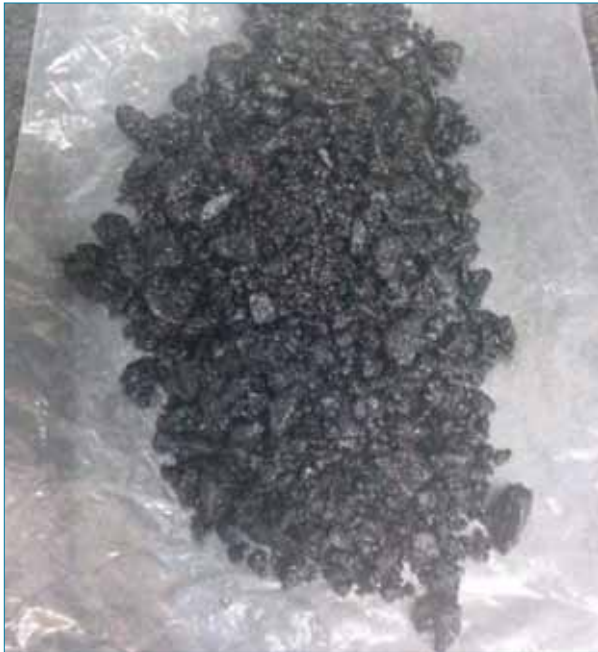
Figura 2: Detalle de la mezcla semicaliente reciclada preparada en laboratorio.
