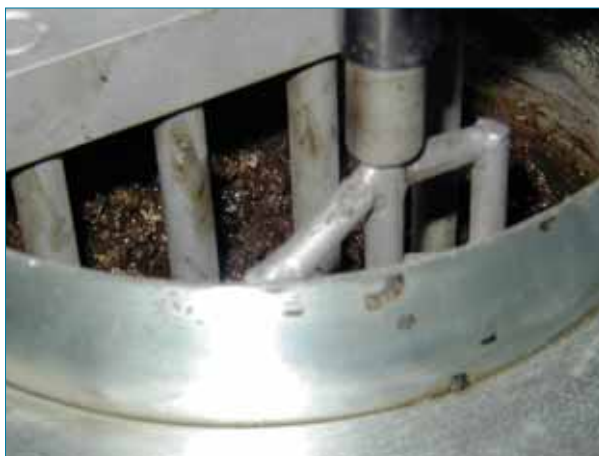
Figura 1. Equipo empleado para el mezclado de los diferentes materiales que componen una mezcla bituminosa.
