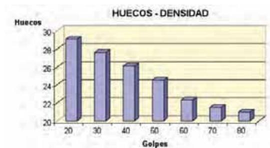
Figura 4: Porcentaje de huecos de las probetas para distintas energías de compactación (golpes por una cara).
