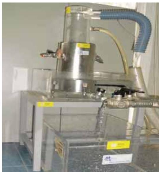
Foto 3: Equipo de medida de la permeabilidad vertical.
