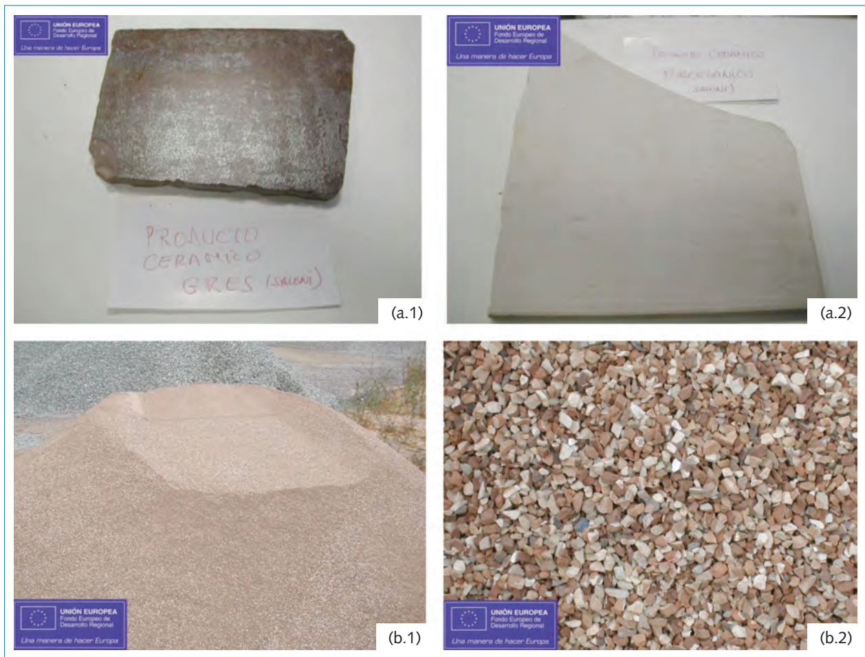
Figura 2. (a) Residuo cerámico: a.1) Tipo gres, a.2) Tipo porcelánico; (b). Árido cerámico tratado: b.1) Fracción fina 0-4 mm, b.2) Fracción gruesa 4-11 mm
