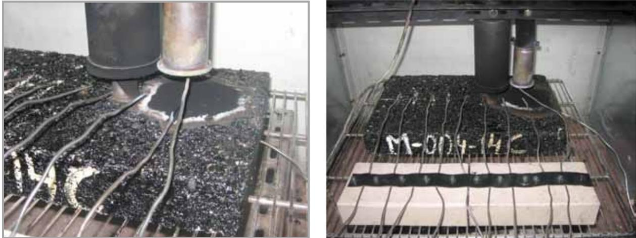
Figura 9. Muestra de AC16S sílice tras el ensayo aditivada al 1,0% (izda.) y con el 1,4% (dcha.).
