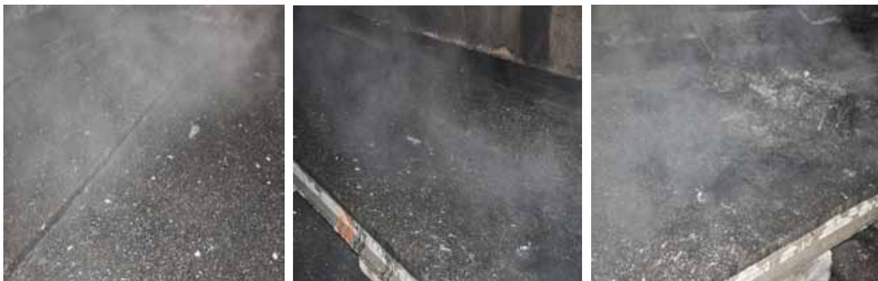
Figura 25. Estado del firme superficial de la mezcla bituminosa AC16S aditivada con el 1,4% después del ensayo con incendio de un coche.
