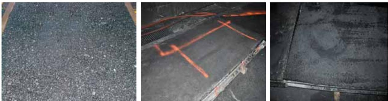
Figura 19. Estado superficial de la mezcla bituminosa: antes del ensayo (izq.), después del ensayo de fuego, blanco (medio) y mezcla aditivada (dcha.).
