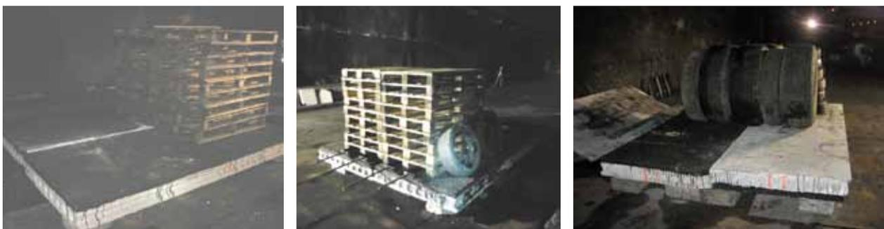
Figura 14. Fotos de la disposición de la carga de fuego: torres de pallets y neumáticos sobre las placas de asfalto.
