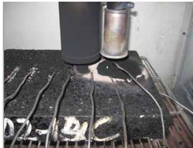
Figura 7. Muestra de AC16S sílice sin aditivar "blanco", durante el ensayo (izda.) después del ensayo (dcha.).
