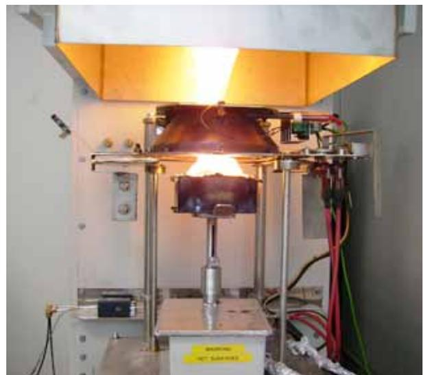
Figura 1: Representación esquemática del cono calorimétrico.
