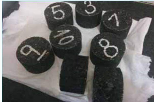
Figura 3. Probetas de mezcla semicaliente reciclada.
