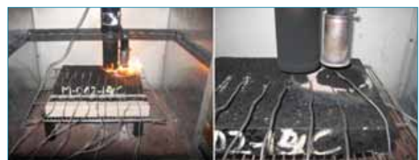
Figura 7: Muestra de AC16S sílice sin aditivar "blanco", durante el ensayo (izda.) después del ensayo (dcha.)
