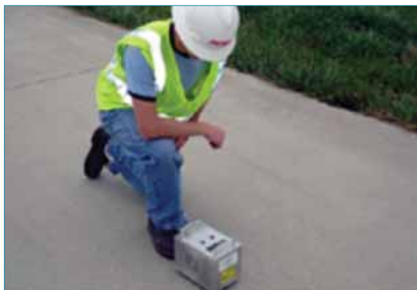
Figura 1. Texturómetro laser portátil. Fuente AMES Engineering.
