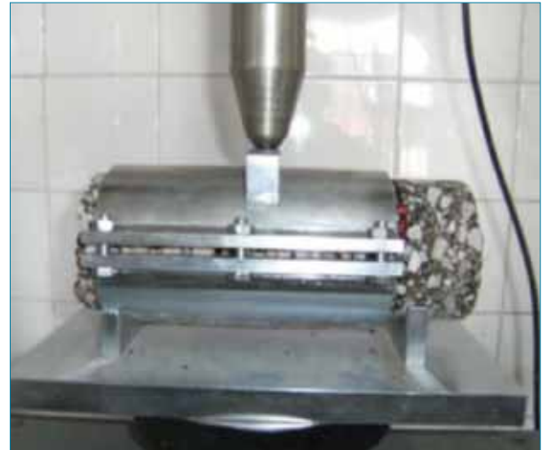
Figura 3. Dispositivo B -NLT-382 (Fuente París et al [6]).
