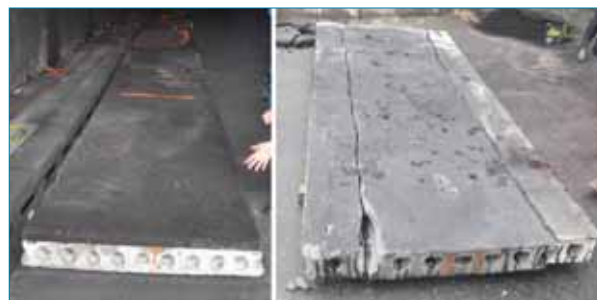
Figura 21: Estado superficial de la mezcla bituminosa después del ensayo de fuego, mezcla aditivada (izq.) y placa de hormigón (dcha.)
