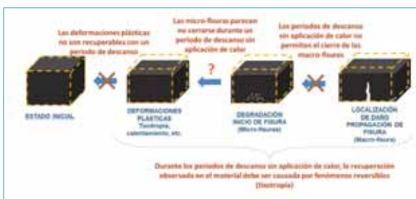
Figura 12. Esquema de los fenómenos ocurridos durante la recuperación de propiedades debido a la inclusión de un periodo de descanso.
