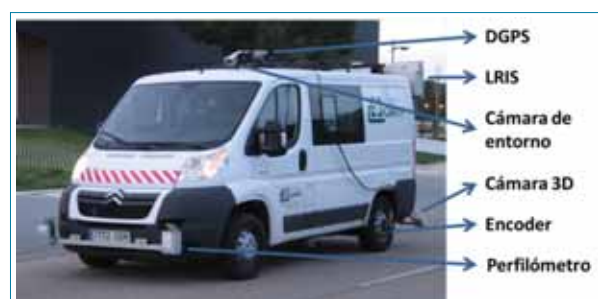
Figura 1. Vehículo de inspección de carreteras.
