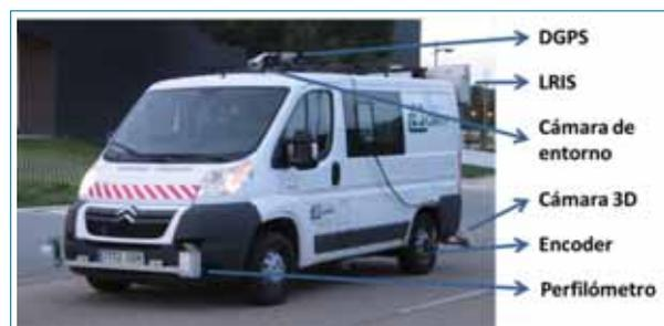
Figura 1. Vehículo de inspección de carreteras.
