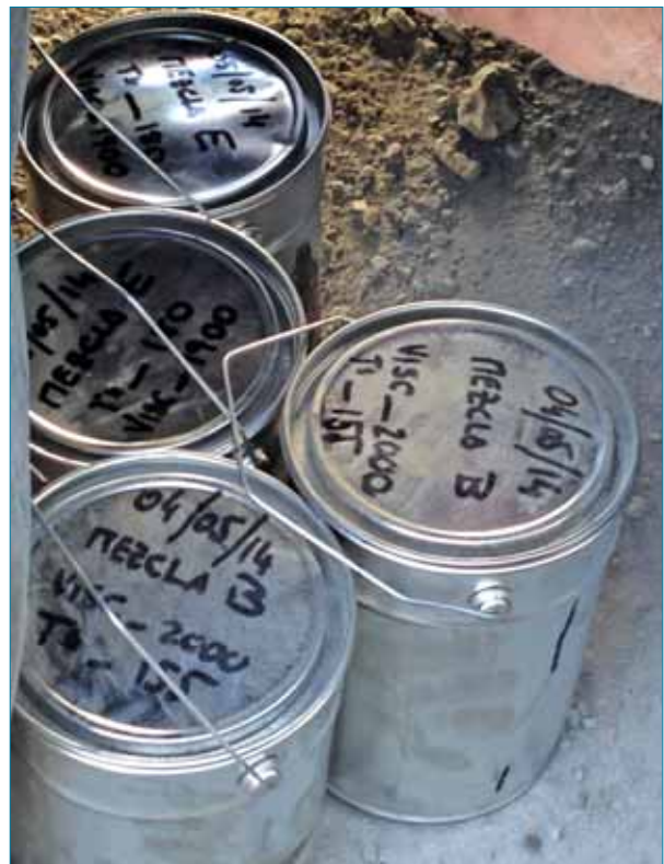
Figura 11. Muestras de betún tomadas durante la obra.
