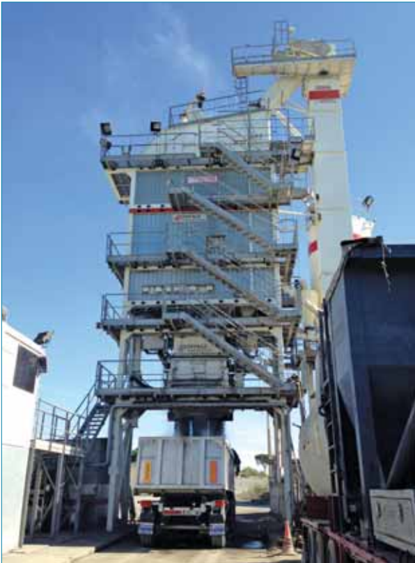
Figura 9. Planta de fabricación de mezclas. A la derecha equipo de modificación de betunes.
