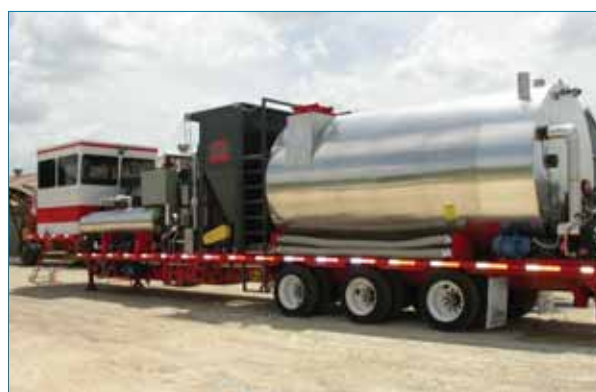
Figura 8. Equipo de fabricación in situ de betunes modificados.
