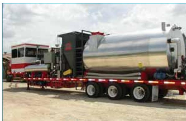
Figura 8. Equipo de fabricación in situ de betunes modificados.
