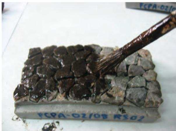
Figura 7: Aplicación del recubrimiento superficial.
