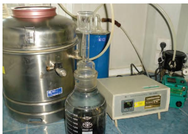
Figura 1. Equipo completo para la determinación de la densidad máxima según el procedimiento A.
