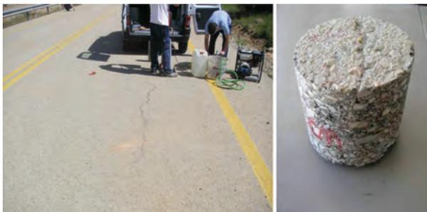
Figura 6. Aspecto de la fisuración descendente en la carretera N-111 (la fisura afecta a la capa de rodadura y muy poco a la intermedia).
