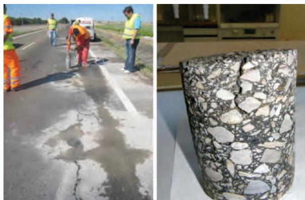
Figura 4. Extracción de testigos en la CL-602. El testigo evidencia fisuración descendente.
