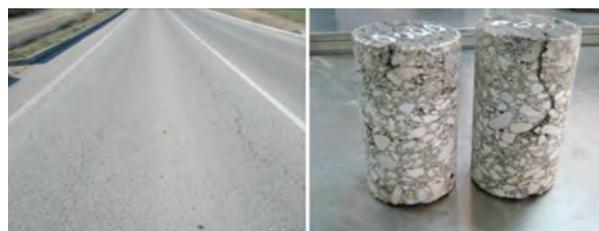
Figura 2. Aspecto de la carretera C-681 y dos de los testigos extraídos.
