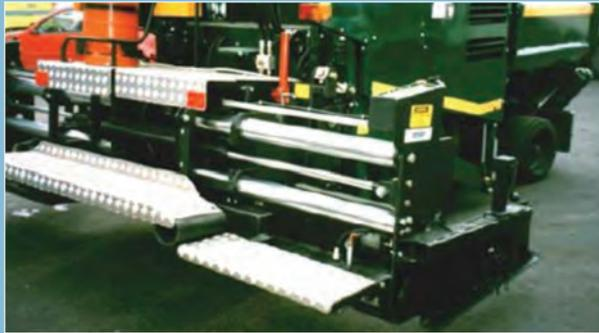
ción a la anchura de extendido de modo continuo y sin detener la máquina.
