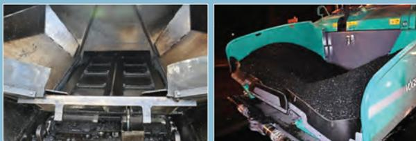
Tolva de recepción de la mezcla y sistema de alimentación a la regla de extendido.
