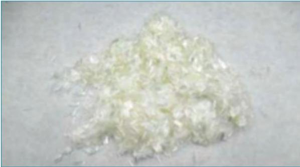
Figura 1. Aspecto visual de las fibras acrílicas utilizadas.
