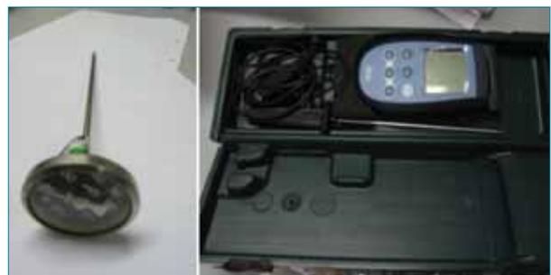
Fotos de termómetros y bimetálico y electrónico.
