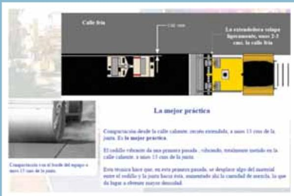
Sistema alternativo de compactación de una junta longitudinal fría.
