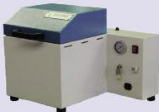
**EQUIPO PARA ENVEJECIMIENTO DE PROBETAS ASFÁLTICAS (SATS)**
