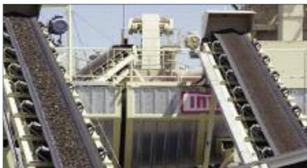
Figura 7: Fracciones de RAP clasificado: aportación a tolvas dosificadoras.
