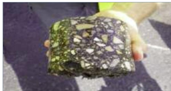
Foto 12: Testigo de obra con MTR a tasa total.
