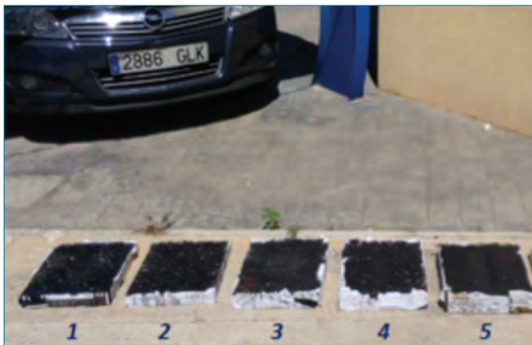
Foto 7.- Exposición de muestras de mezclas bituminosas.
