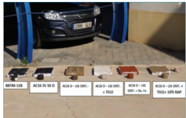
Foto 13.- Mezclas expuestas a los efectos de la radiación solar.
