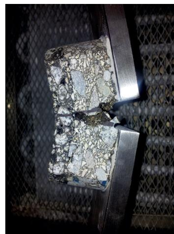
Figura 8. Detalle de la rotura de un testigo con entalla en la cara inferior, con capa ultradelgada. Tensión aplicada en la cara inferior del testigo
