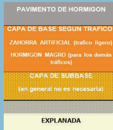
Figura 4: Sección tipo de un firme RÍGIDO
