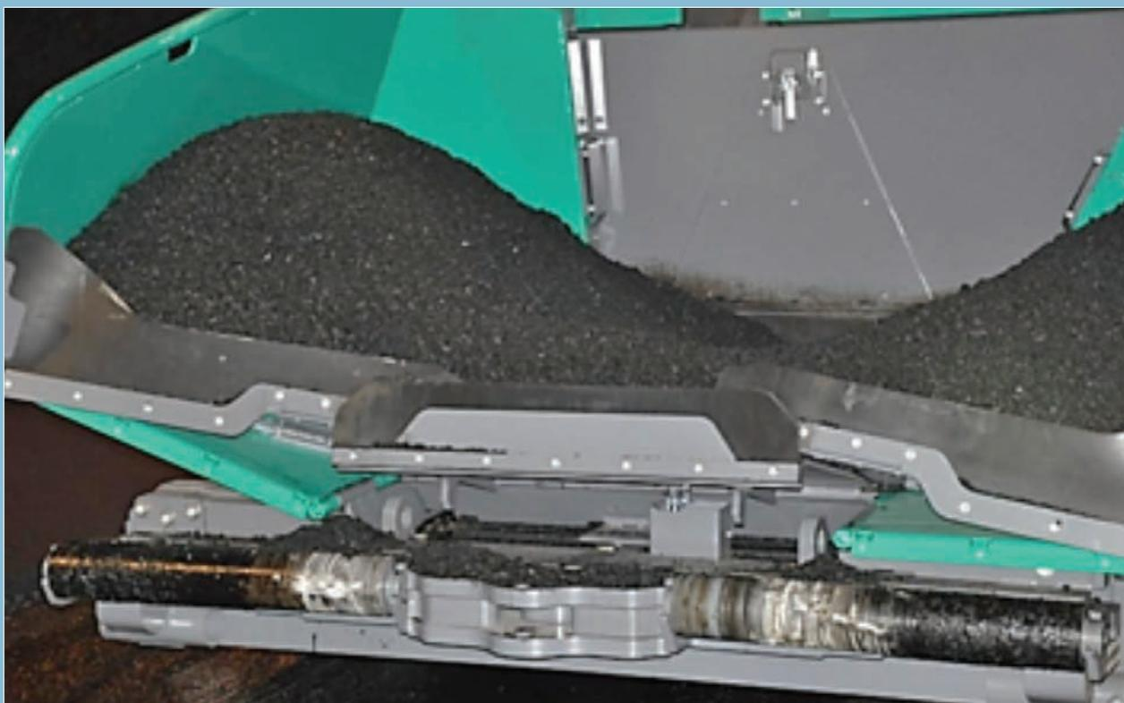
A la izquierda, tolva receptora de la mezcla bituminosa. A la derecha, derrame incontrolado de mezcla bituminosa.
