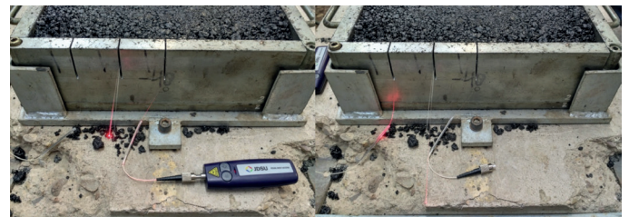
Figura 6. Prueba con ranura y producto para sellado de grietas. Comprobación de la supervivencia de los hilos de fibra al proceso de compactación.
