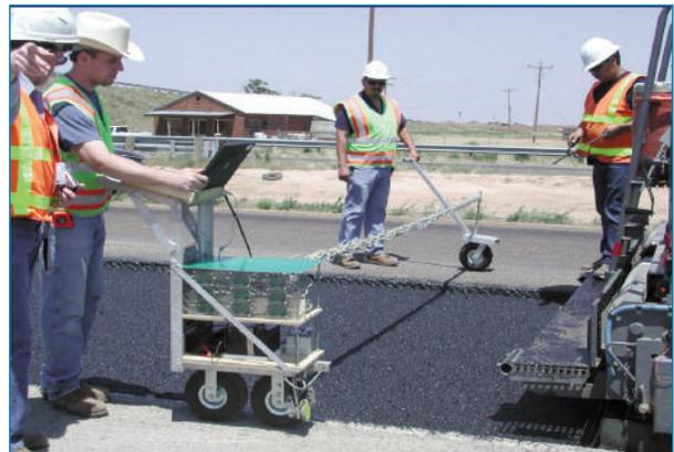
Figura 10. Prototipo Pave-IR. Fuente Texas DOT
