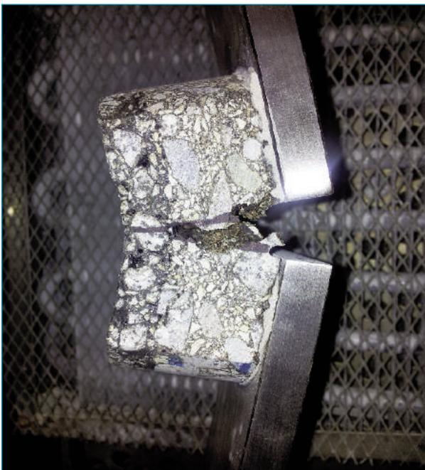
Figura 11. Detalle de la rotura de un testigo con entalla en la cara inferior, con capa ultrafina. Tensión aplicada en la cara inferior del testigo
