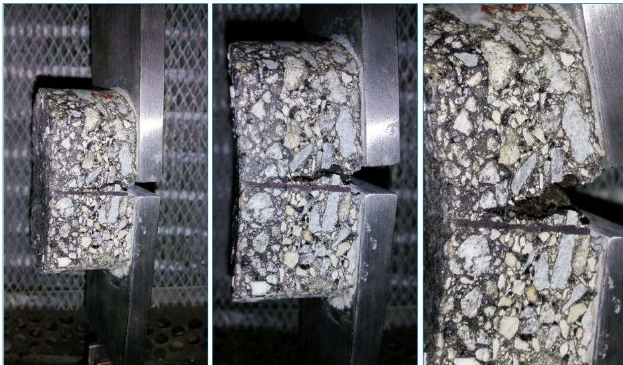
Figura 13. Comportamiento de la capa ultrafina frente la progresiva apertura de la fisura en la cara inferior del testigo
