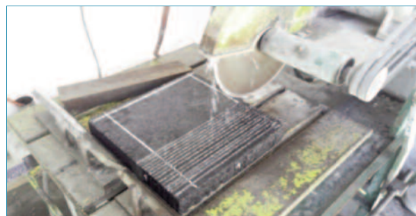
Figura 3. Simulación fresado probeta Caso 1
