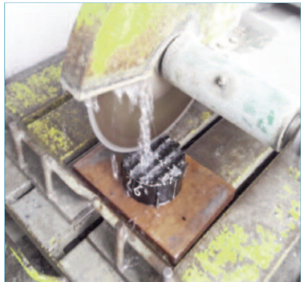
Figura 5. Aserrado de una probeta del Caso 5
