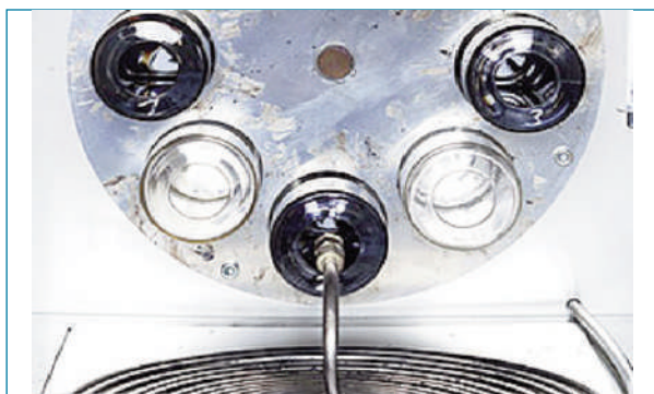
Ilustración 4: Carrusel de muestras en estufa RTFOT
