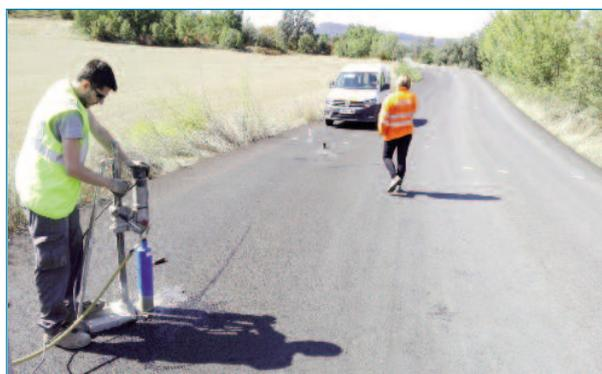
Figura 11: Extracción de testigos para la medida de la textura de las mezclas
