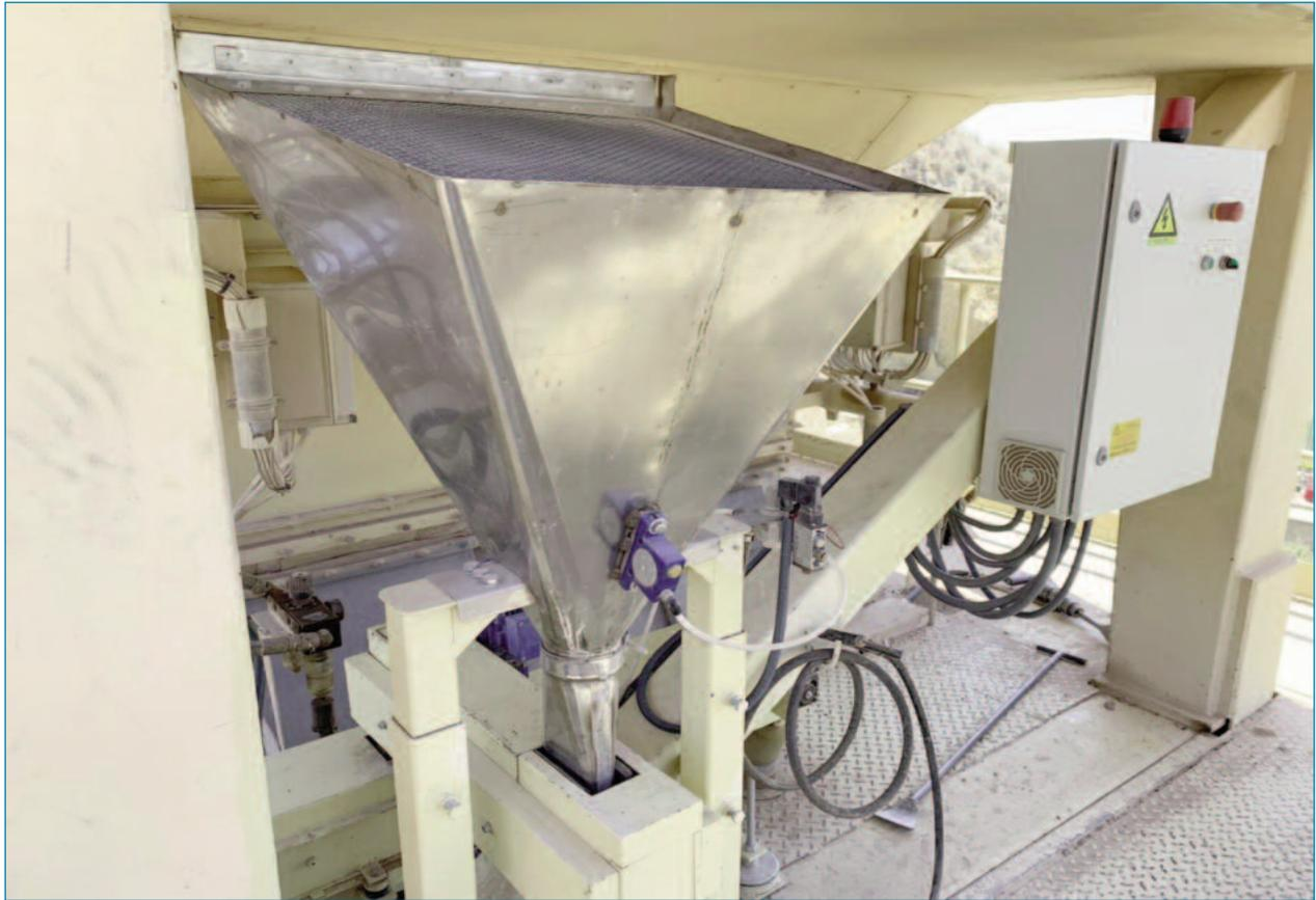
Figura 4. Sistema de dispensación de aditivo en base grafeno en planta
