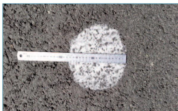
Figura 12: Detalle de la medida del círculo de arena
