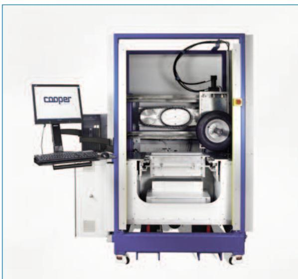
Foto 1. Compactador de rueda neumática.
