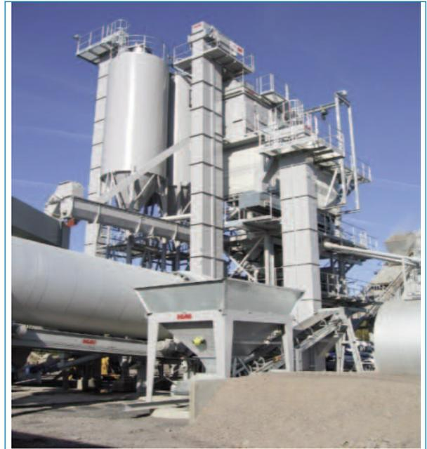
Figura 8: En primer término, tolva para la incorporación de una fracción de material fresado, a temperatura ambiente, directamente a la mezcladora.
