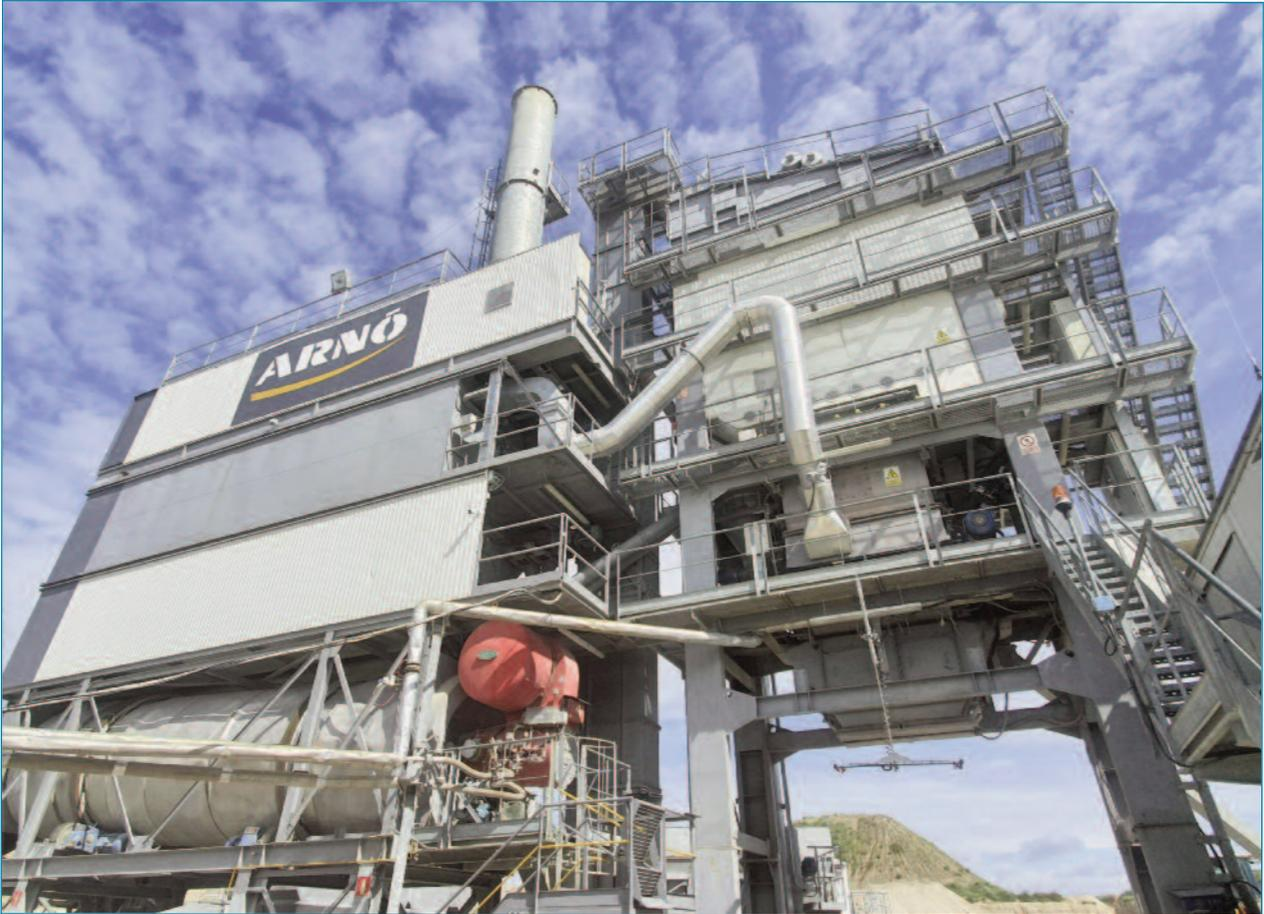
Figura 9. Torre de una central de fabricación equipada con un sistema de evacuación del vapor generado cuando se introduce árido o RAP directamente en la mezcladora.
