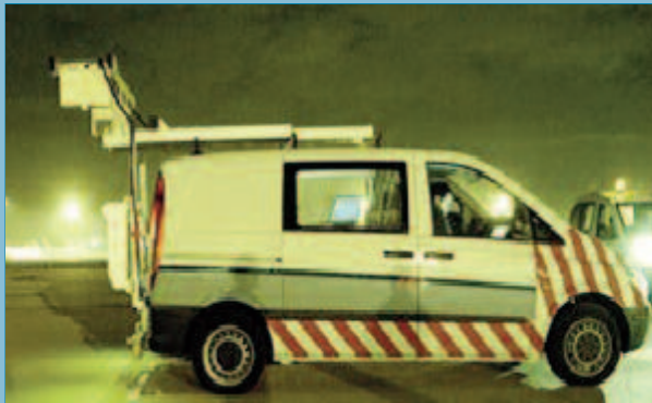
Figura 133.- Sistema de imágenes 3D del pavimento para la detección de deterioros.
