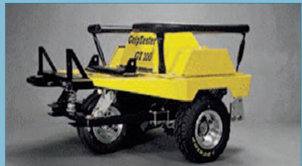
Figura 129.- Equipo Grip-Tester para la medida del coeficiente de rozamiento longitudinal.
