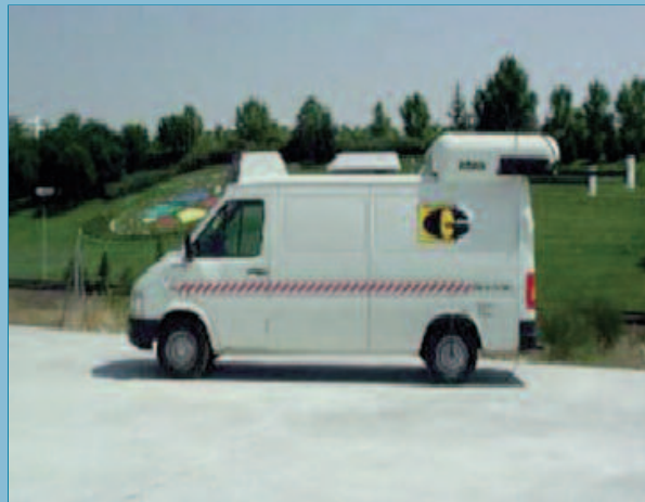
Figura 132.- Equipo de medida de las características superficiales del pavimento
