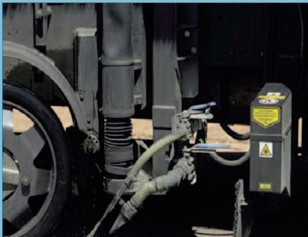
Figura 131.- Texturómetro láser montado sobre SCRIM.
