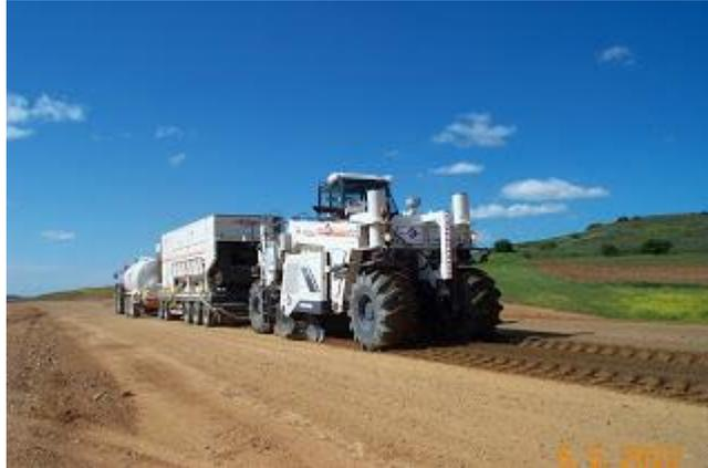
Equipo de reciclado in situ con cemento
