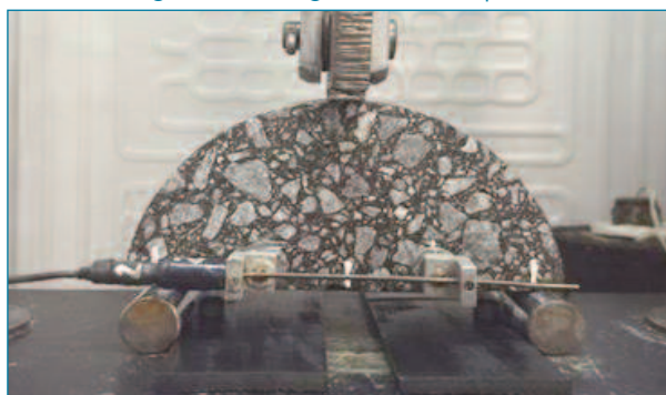
Figura 1(b). Probeta instrumentada para el ensayo propuesto
