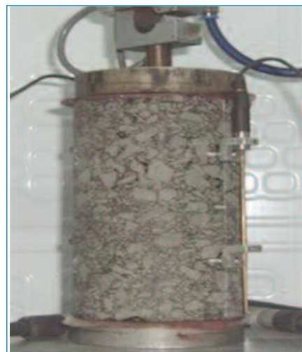
Figura 5. Probeta para ensayo de Compresión Uniaxial
