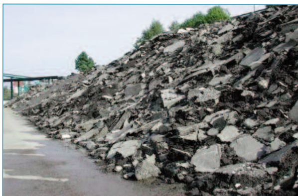
Figura 4. Bloques de material RAP apilados en planta
