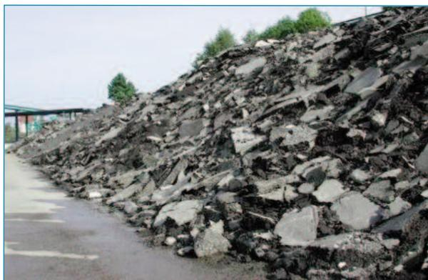
Figura 4. Bloques de material RAP apilados en planta
