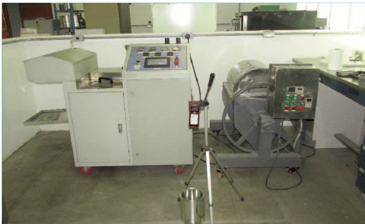
Figura 2. Equipo de espumado completo que lo conforma: dispositivo de espumado, mezclador de asfalto y distanciómetro láser (Fuente: elaboración propia) Lasfalto S de R. L. .
