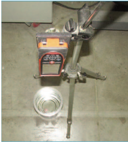
Figura 4. Distanciómetro láser para la medición de coeficiente de expansión y vida media del espumado (Fuente: elaboración propia) Lasfalto S. de R. L.
