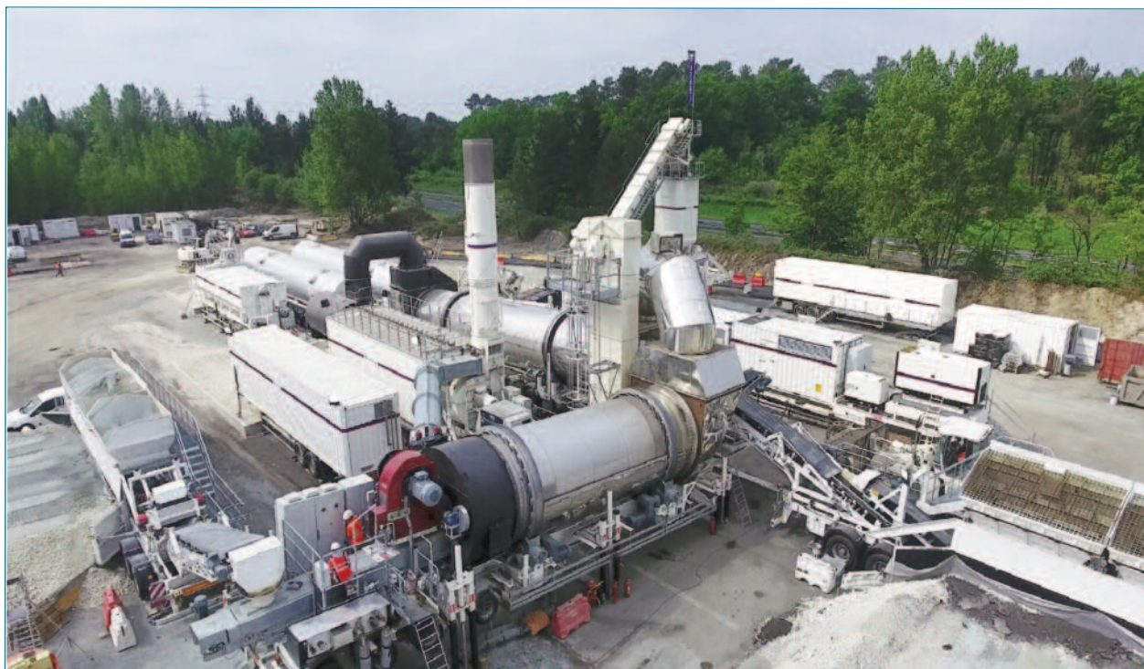
Foto 1. Imagen de la planta de aglomerado móvil de nueva generación
