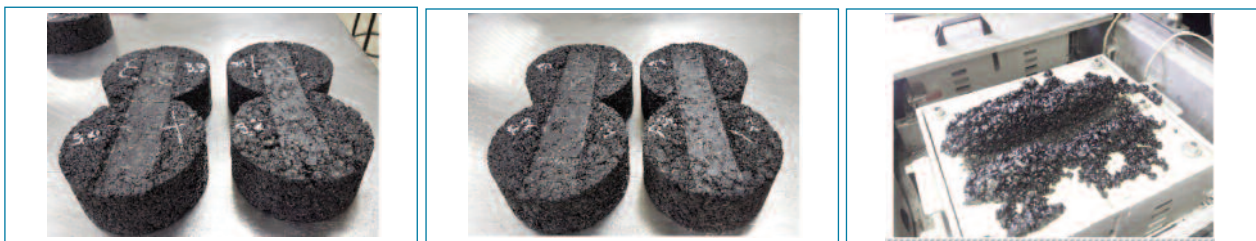
Figura 17. (a) Ahuellamiento de las mezclas evaluadas. (a) Mezcla convencional (b) Mezcla Reciclada (c) Mezcla predosificada.
