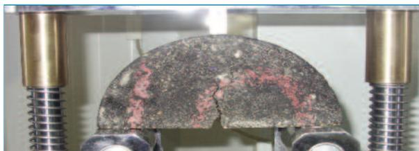
figura 2. Probeta durante el ensayo de rotura.
