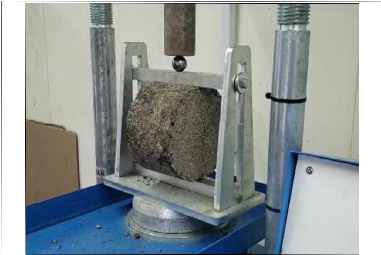
Figura 8. Ensayo de resistencia a la tracción indirecta
