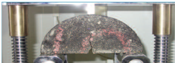
figura 2. Probeta durante el ensayo de rotura.
