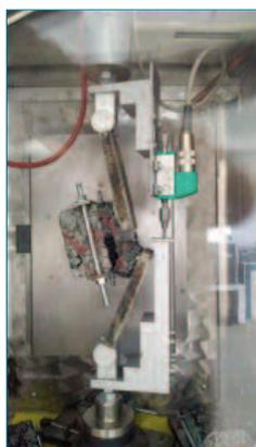
Figura 10. Ejecución de ensayo de adherencia
