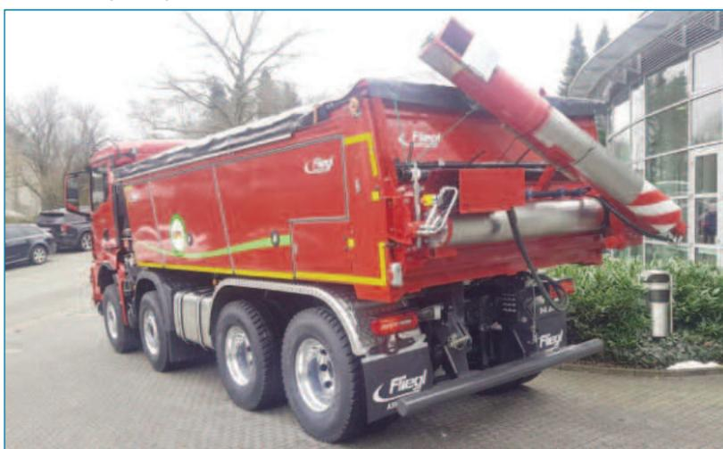
Camión calorifugado ASW stone truck “Asphaltprofi-Thermo” de 15 m<sup>3</sup>
