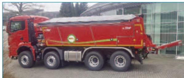
La tecnología "push-off" patentada por Fliegl está dotada de loma calorifugada "Cramaro" y las paredes de aislamiento garantizan la máxima homogeneidad térmica
