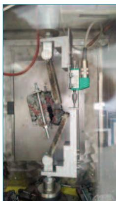
Figura 10. Ejecución de ensayo de adherencia
