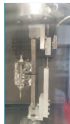
Figura 9. Ejecución de ensayo de adherencia, con la disposición de los pernos y las pretinas de sujeción de la capa soporte
