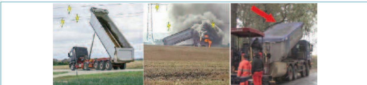
Varios ejemplos de accidentes o limitaciones durante el extendido de la mezcla al levantar la carga
