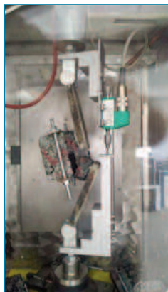
Figura 10. Ejecución de ensayo de adherencia
