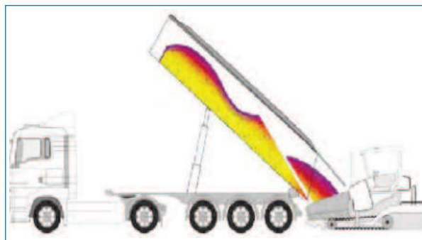
La tecnología convencional de elevación de la carga puede favorecer la acumulación de mezcla bituminosa más fría en la extendidora
