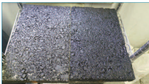
Figura 7. Capa soporte AC16 surf 50/70 S sin emulsión (izda) y con emulsión (dcha)
