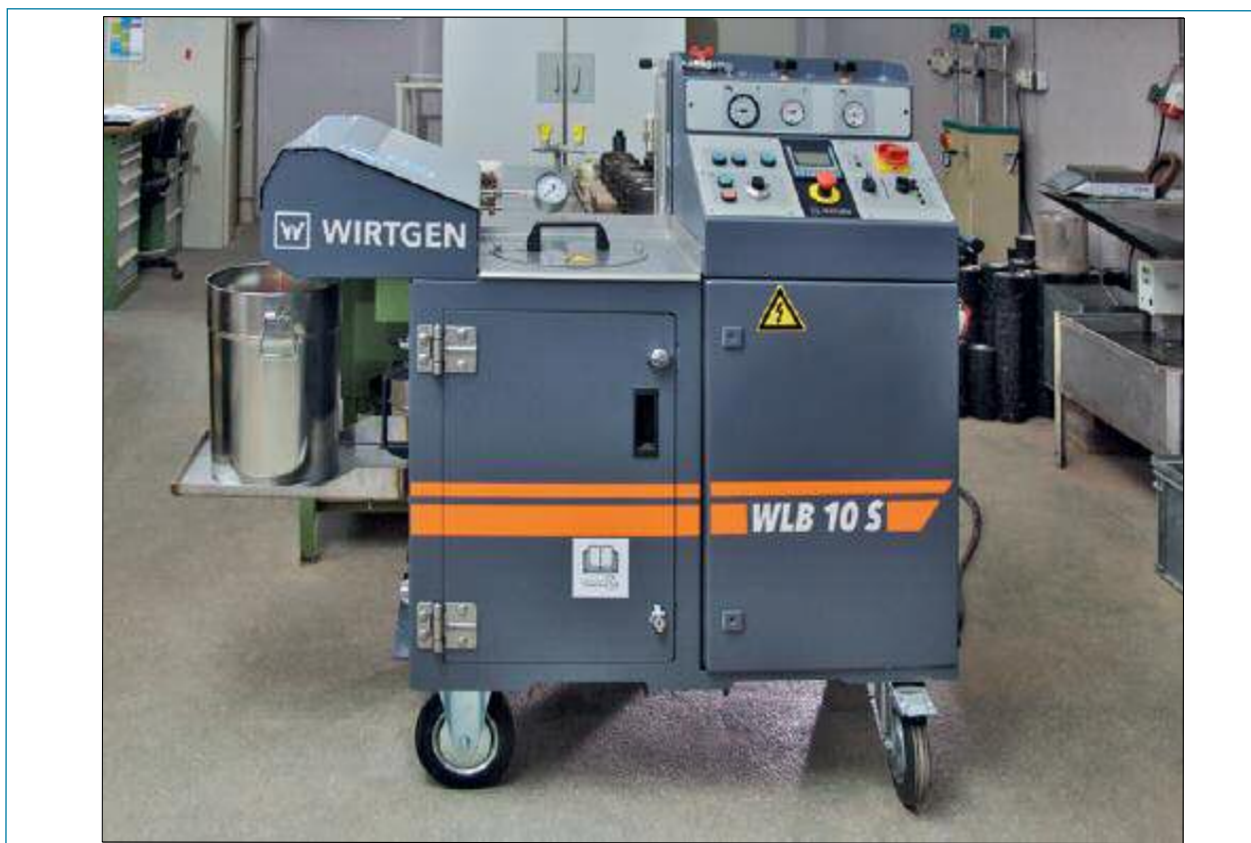
Figura 7. Unidad de espumado de laboratorio [4]
