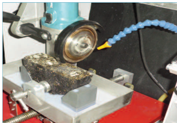
figura 3. Máquina de corte para generar una fisura en probetas.
