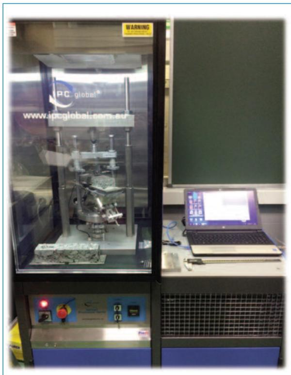
lula de carga debe tener tolerancia de  $\pm 2000$  N y transductores de desplazamiento clase de precisión 0,2 (rango de medición al menos  $\pm 2,5$  mm). Las fuerzas se deben medir en la zona central sobre el cabezal de carga y los desplazamientos horizontales en el centro de separación de los apoyos en la zona inferior la probeta y los verticales en el centro en la zona superior de la probeta.
