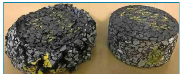
Imagen 1: Probeta después de ensayos de compresión cíclica a 50°C sin (izquierda) y con (derecha) modificación reactiva con B2Last
