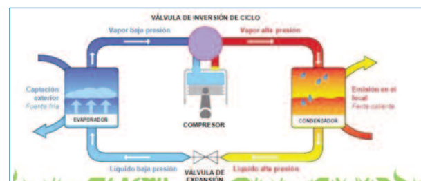
Figura 1. Ejemplo de funcionamiento de una bomba de calor geotérmica
