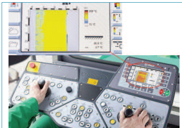
Pantalla del sistema y datos térmicos reflejados
