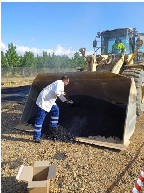
Figura 2. Imagen explicativa sobre el proceso de toma de muestra de mezcla bituminosa en planta
